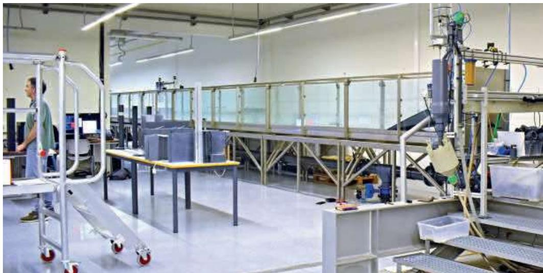
pagación de olas, validada experimentalmente a través de prototipos a escala de las cámaras de la central de Mutriku en sus propias instalaciones de la Escuela de Ingeniería de Bilbao (wave-flume).
