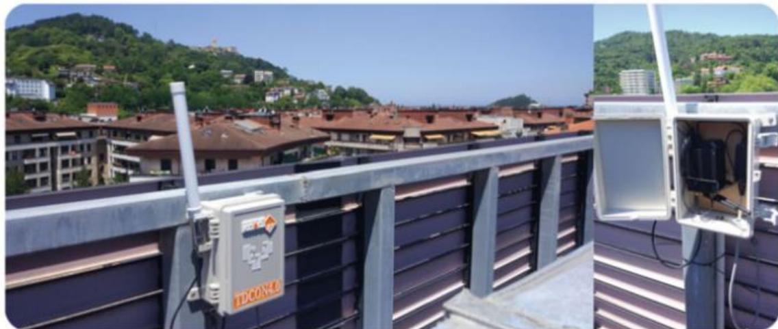
Figura 11: Gateway IoT instalado en la azotea de la escuela
