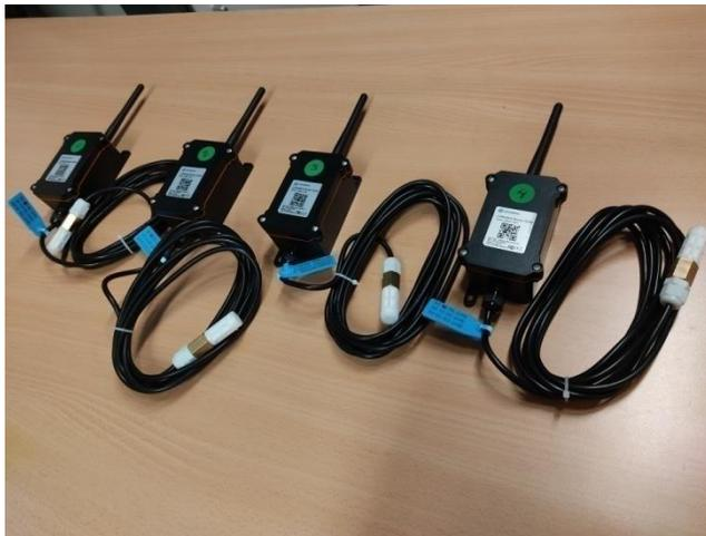
Figura 10: Sensores IoT de temperatura y humedad relativa
