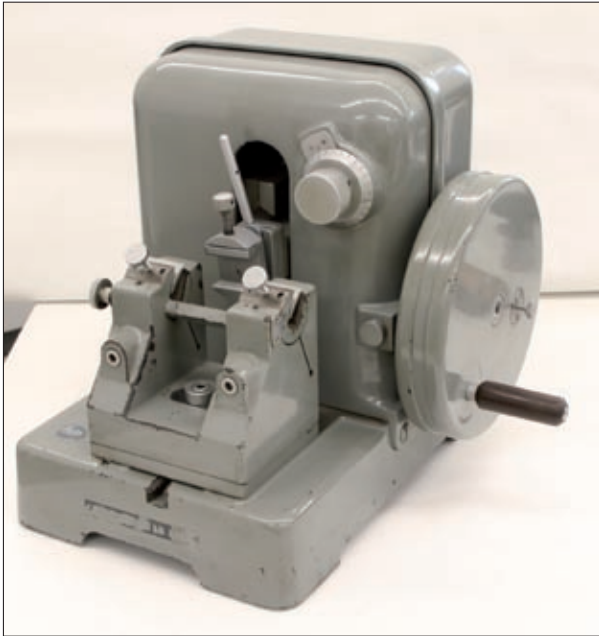
55. Errotazio mikrotomoa Ernst Leitz GMBH Wetzlar Microtomo rotatorio Ernst Leitz GMBH Wetzlar. Modeloa / Modelo 1212 Alemania. 1970
