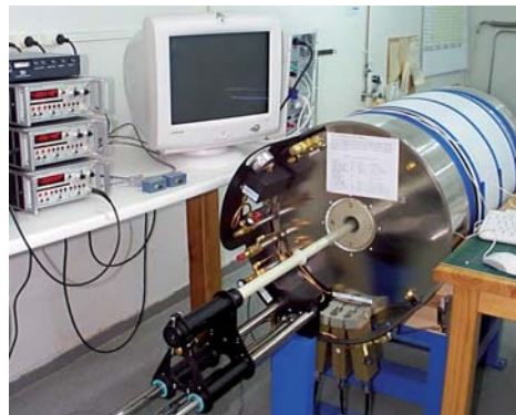
Magnetometro kriogenikoa, sedimentuen magnetizazio fosila neurtzeko erabilia.
