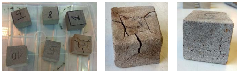
Figura 8: Muestras de piedra ensayadas tras 15 ciclos de cristalización de sales y detalle del deterioro
