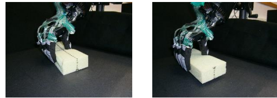
Figura 9: Posiciones finales utilizando el valor de fuerza inicial FI (izq.) y el valor adaptado FA (der.).
