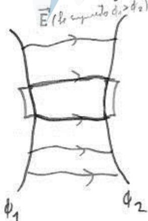
Tomando una superficie infinitesimal a cada lado del punto  $d\vec{l}$ , pudiendo dilujo un cilindro infinitesimal entre los dos conductores, pudiendo dilujo un cilindro infinitesimal con las líneas de campo paralelas a la superficie de dicho cilindro (la líneas que van en 1 vuelan en 2 salvo casos muy extremos).
