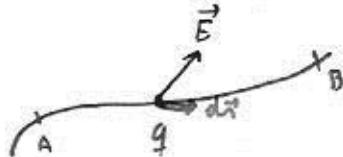
$$W = \int_A^B \vec{F}_e \cdot d\vec{r} = \int_A^B q \vec{E} \cdot d\vec{r} = -q \int_A^B \vec{\nabla} \phi \cdot d\vec{r} = -q \int_A^B dq =$$
