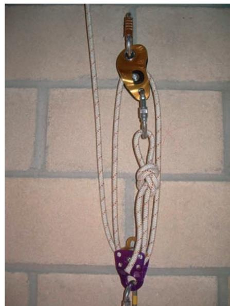
Si además de ascender una carga tenemos que realizar con ella maniobras de descenso tendremos que introducir en el sistema un dispositivo de descenso tipo Stop o I´D.
