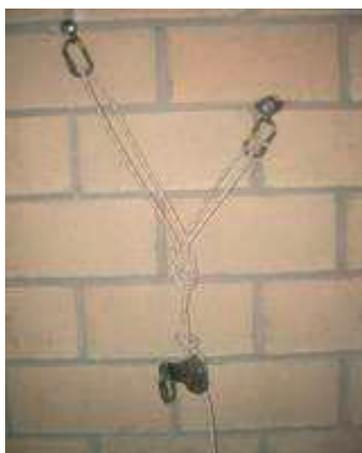
A la hora de colocar las cintas tendremos en cuenta, la posición de los cabos de anclaje y de las cintas, así como la posición de los mosquetones. Una cinta colocada inadecuadamente pierde resistencia, puede pasar de una resistencia de prácticamente 44kN en doble a 8kN si se coloca estrangulada y haciendo palanca.
