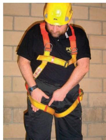
Si el modelo no tiene hebillas automáticas o desmontables deberemos de colocárnoslo sentado o apoyados contra un elemento fijo, para evitar una posible caída al ponérselo.
